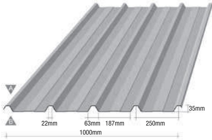
b) Esquema em corte do perfil
